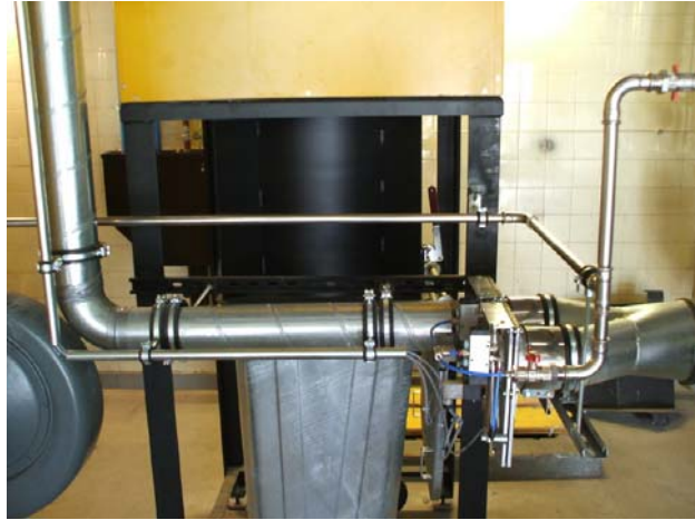
Die Ansaugweiche des „Pelletvac“-Systems
