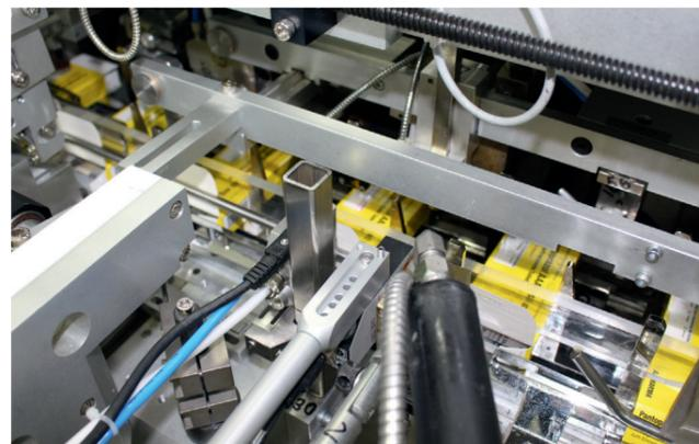
Auftragen des Klebstoffs für einen fälschungssicheren Verschluss
