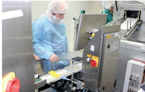
Anlage mit Druckeinheit für die Serialisierung
