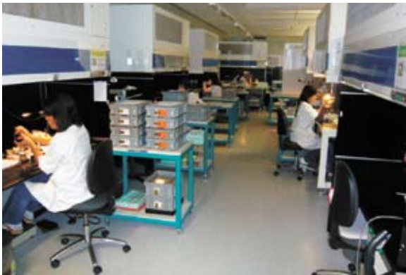
Das neue Layout der Montage im neuen Pavillon. Standardisierte Arbeitsplätze, die dem Materialfluss entlang angeordnet sind, um eine hohe Transparenz und Übersichtlichkeit zu erzielen, Transportwege zu verkürzen sowie Kreuzungen zu vermeiden.
