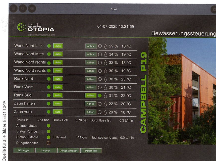
Bild 1: Dashboard der Bewässerungssteuerung mit relevanten Parametern, wie Füllstand der Zisternen und Pumpenstatus.
