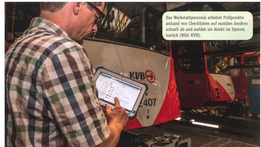
Das Werkstattpersonal arbeitet Prüfpunkte anhand von Checklisten auf mobilen Geräten schnell ab und meldet sie direkt im System zurück (Bild: KVB).
