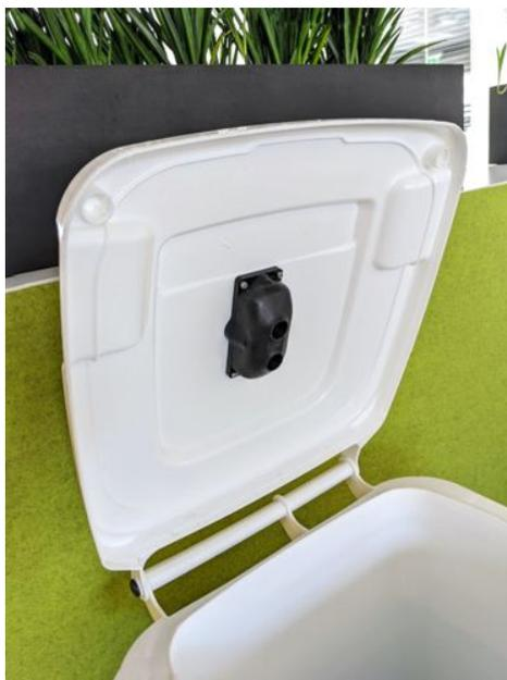
Vollständig in office:map integrierbar: LoRa/5G-basierter Behälterprototyp mit Füllstands-sensoren. (Foto: rona:systems)
